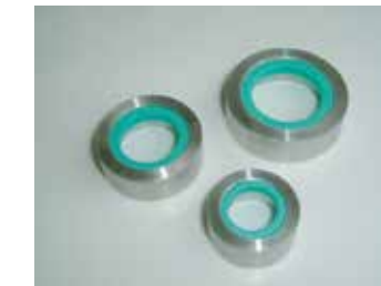
特殊検査リングでアンカーボルトの引抜き耐力試験を行います。
